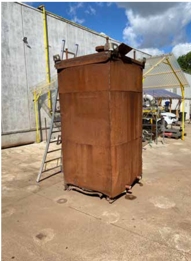
Figuur 4. Links: de container voor het ex situ-experiment werd gevuld met grond en wortelstokken van Japanse duizendknoop en verhit tot 80 °C. Rechts: de container is geïsoleerd om warmteverlies langs de zijanten te verminderen. (© Haemers Technologies)
