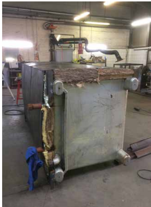
Figuur 4. Links: de container voor het ex situ-experiment werd gevuld met grond en wortelstokken van Japanse duizendknoop en verhit tot 80 °C. Rechts: de container is geïsoleerd om warmteverlies langs de zijanten te verminderen. (© Haemers Technologies)
