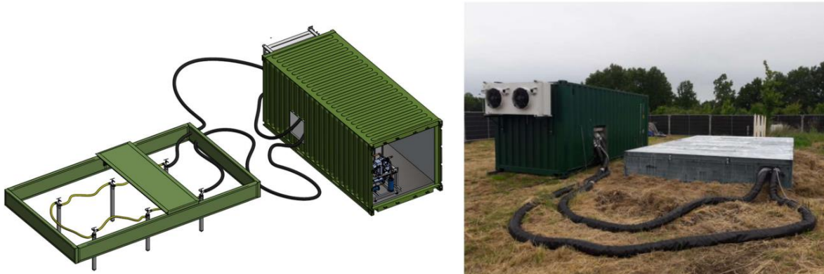
Figuur 4 Schematische weergave koude-installatie (links) en rechts de installatie in het veld (Foto TIBACH).
