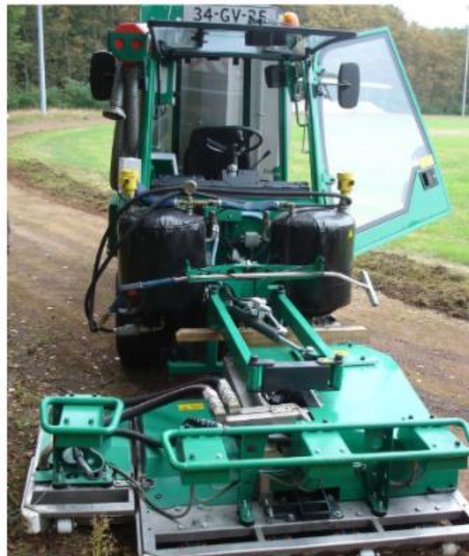
Thermische onkruidbestrijding met heet water (Inverde, Valentijn De Cock)
